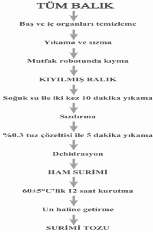
Şekil 1. Surimi tozu üretim şeması
